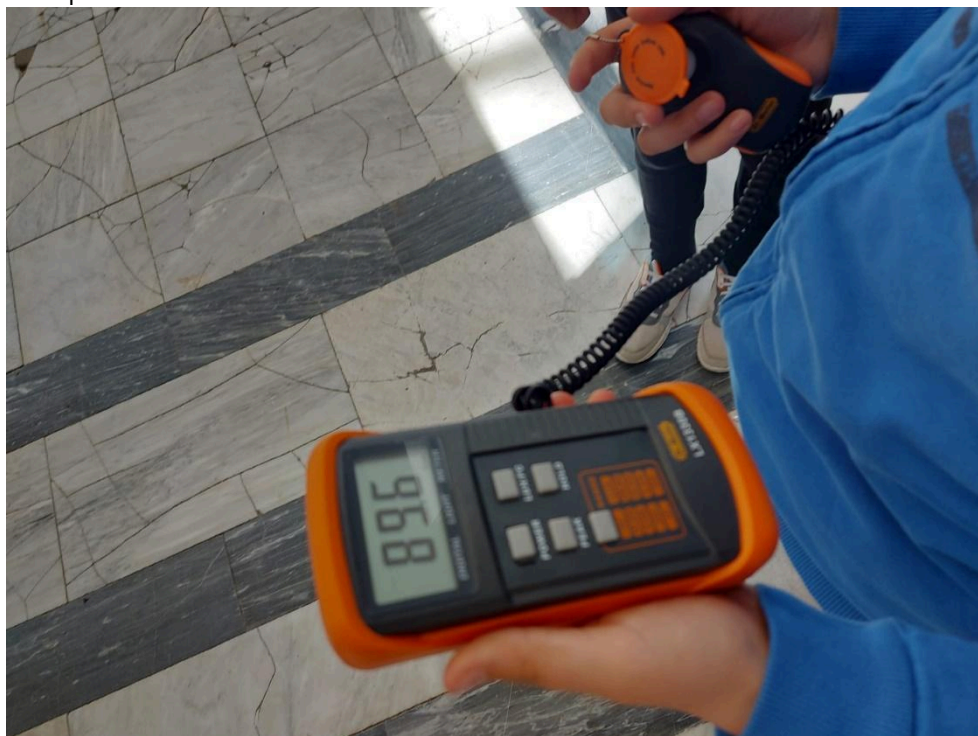
Slika 6. Mjerenje intenziteta svjetlosti (autor: A.Šimac)
